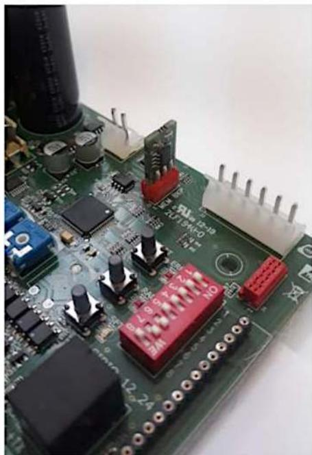
EN SU INTERIOR CONTIENE LOS CÓDIGOS DE RADIO Y LOS TIEMPOS DE TRABAJO. CADA VEZ QUE SE INSERTA UN CÓDIGO DE RADIO, SE MEMORIZA AUTOMÁTICAMENTE EN LA TARJETA, SI ESTÁ INTRODUCIDA
